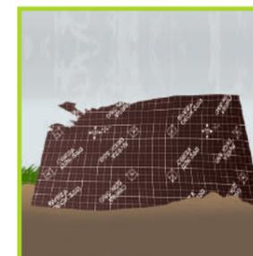
После демонтажа опалубки осмотрите фанеру. Удалите остатки бетона. Не используйте сильно деформированные листы для дальнейших заливок. Если повреждения незначительны, используйте листы на доборы.
